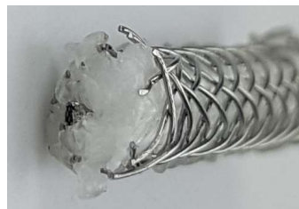
Sensorkabel durch Hitzeeinwirkung: Innenleiter macht Kurzschluss mit dem Außenleiter
