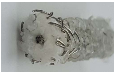
Sensorkabel noch Original: Innenleiter in der Mitte
