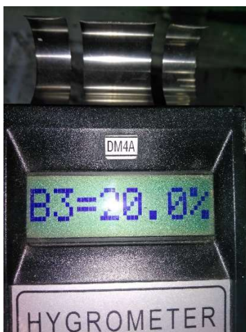
Abbildung 10 Feuchtigkeit eines Stücks gebundener Schüttung an der Grenze zum Estrich der Duschtasse
