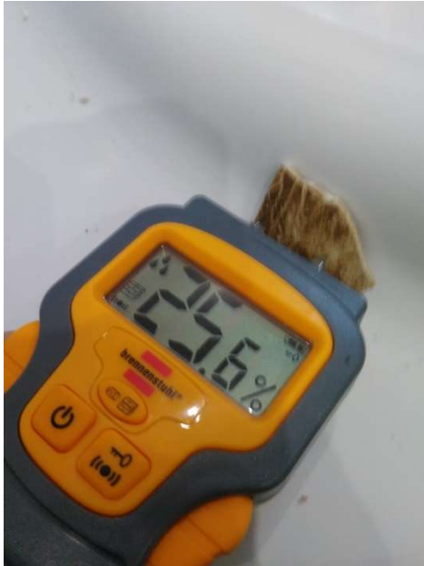
Abbildung 11 Feuchtemessung eines entfernten Stücks gebundener Schüttung von der Schweißbahn des Rohfußbodens, Feuchtigkeit ist fühlbar vorhanden 05.02.2020
