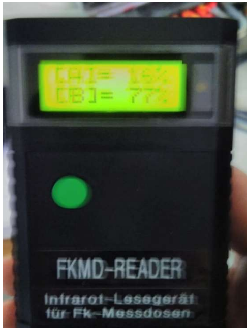
Abbildung 2 Auslesung via Infrarot der Messdose
