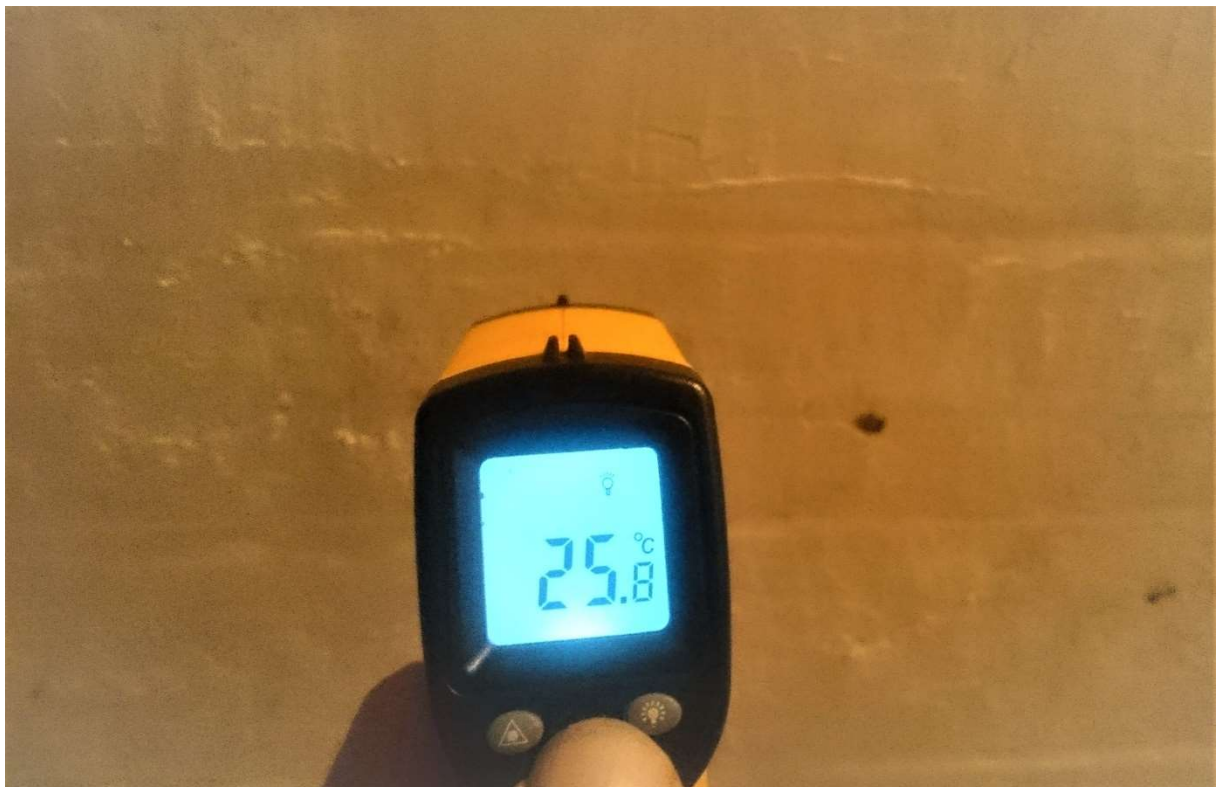
Temperaturmessung der Wand innerhalb der beheizten Fläche
