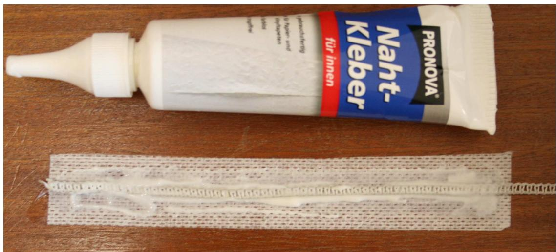
3. Papierstreifen zur Fixierung und Abdeckung. Zur Feuchtemessung und Überwachung, das Sensorkabel „F“ an das Messmodul anschließen.
